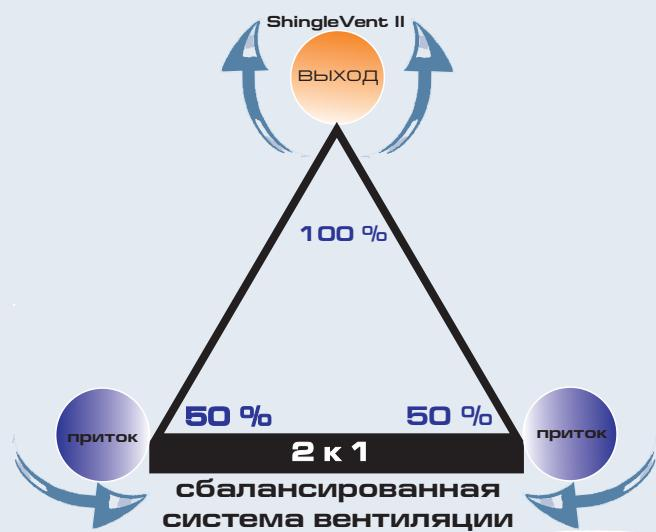
ShingleVent II, является неотъемлимой частью сбалансированной системы вентиляции, которая обеспечивает стабильное и непрерывное движение воздушного потока в подкровельном пространстве на протяжении всего срока эксплуатации здания.
